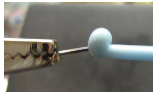
Glasstück mit einer Zange halten und vorsichtig erwärmen. Gleichzeitig im hinteren Bereich der Flamme die Spitze des Ohrsteckers kurz zum Glühen bringen. Das weiche Glas auf die Steckerspitze „stecken“.
